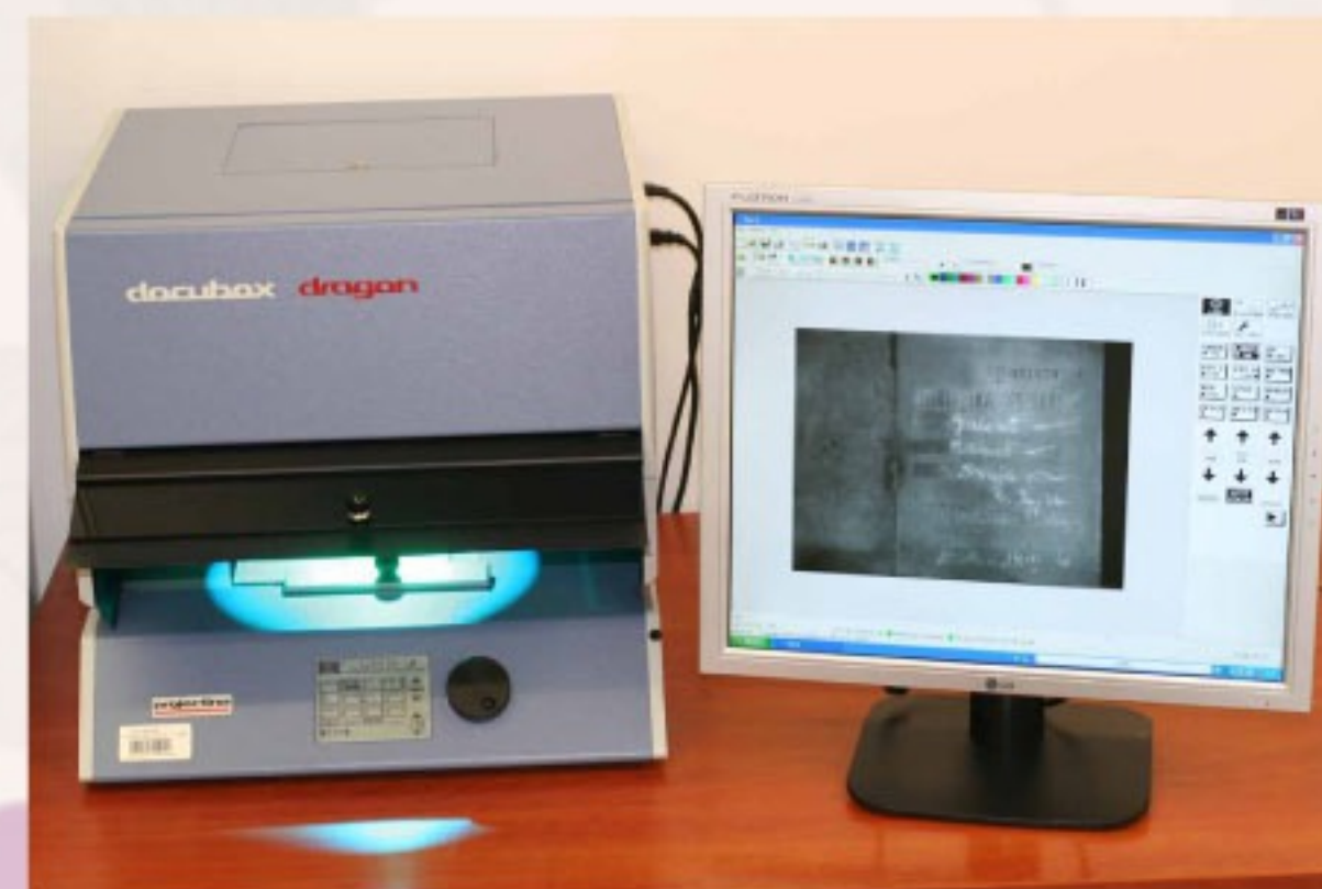
Wideo komparator umożliwiający odczytywanie zapisów, które uległy degradacji lub świadomie zostały zamazane, 2010, IPN, fot. Paweł Zieliński
