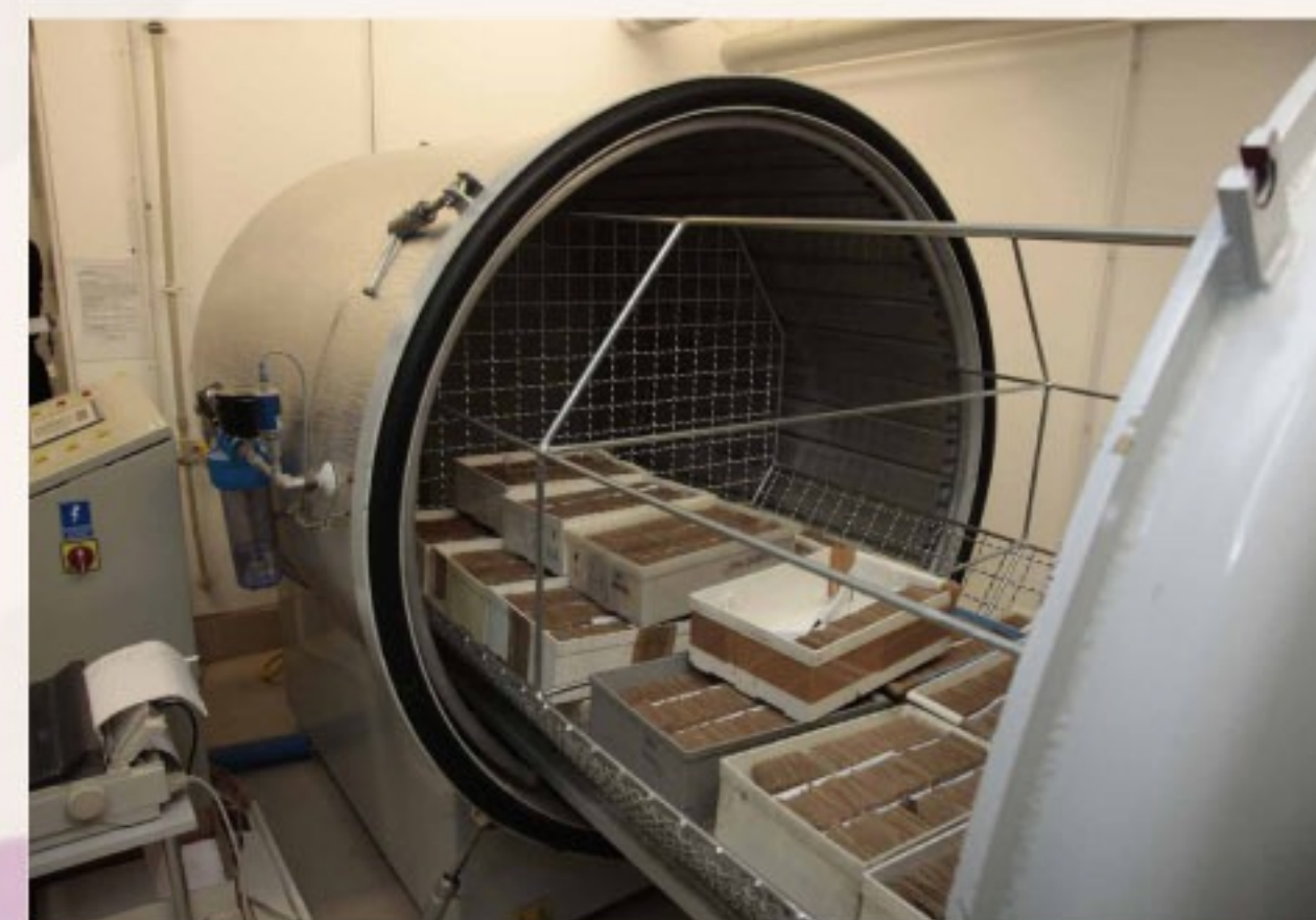
Komora fumigacyjna, w której jednorazowo dezynfekuje się do 2 m 2 dokumentacji aktowej, 2009, IPN, fot. Piotr Życieński
